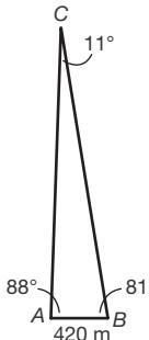
$$\angle ACB = 180^\circ - 88^\circ - 81^\circ = 11^\circ$$
